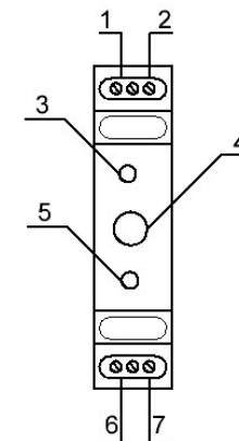
Рис. 1. Вид сверху. 1. Клемма контактов реле. 2. Клемма контактов реле. 3. Лампа питания. 4. Регулятор значения температуры. 5. Лампа состояния реле. 6. Клемма подключения фазного провода. 7. Клемма подключения нейтрали.
